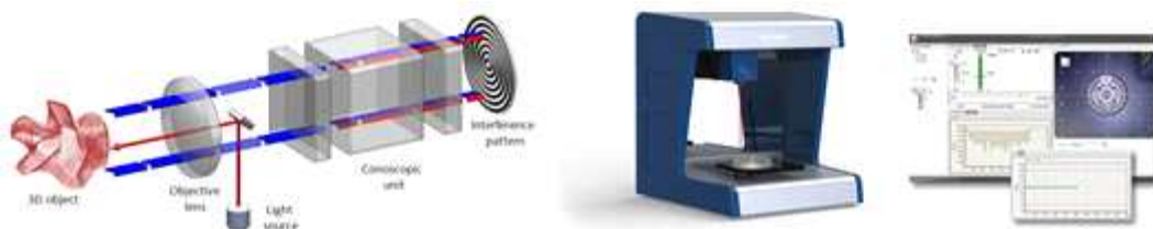
[그림] Conoscopic Holography 3D 측정 원리 및 Optimet社 3차원 스캐너
